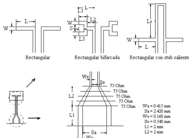
Figura 1. Configuraciones de slot y transición progresiva.
