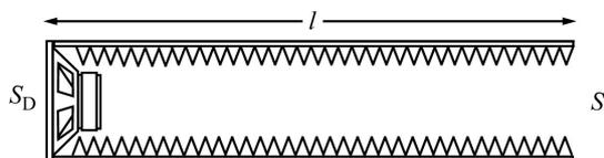
Figura 1. Línea de transmisión acústica.
