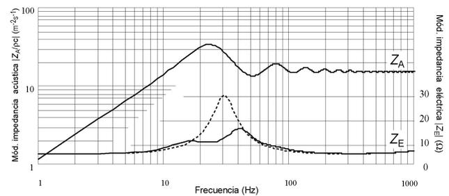
Figura 4. Impedancias eléctrica y acústica normalizada.
