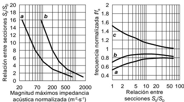
Figura 3. Relación entre secciones transversales y la frecuencia y magnitud de la impedancia acústica.
