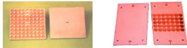
Figura 1. Fotografía de las antenas fabricadas: con sustrato PBG y convencional (izquierda) y circuitos enfrentados sobre sustrato convencional y PBG (derecha).
