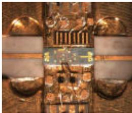
Figura 4. Fotografía del montaje de amplificador MMIC de 3 etapas con los circuitos de polarización
