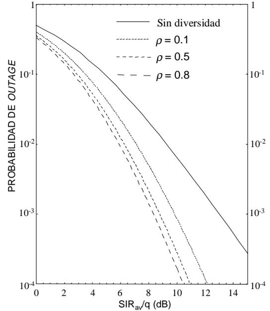
Figura 1. Probabilidad de outage de un combinador por selección de dos ramas. Parámetros de forma  $m = 3$  y  $m_I = 3$ .
